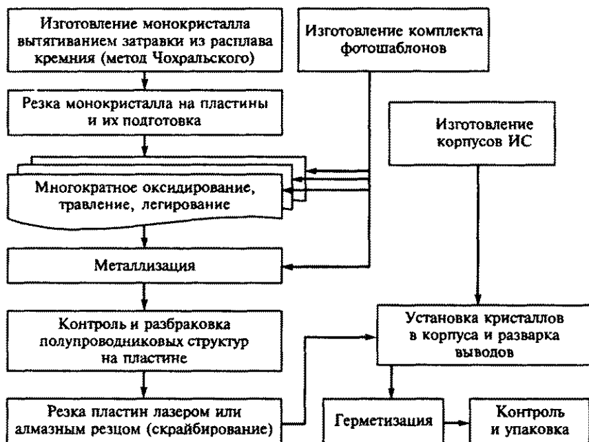
Рис. 7.1. Увеличенная схема ТП изготовления полупроводниковых (монокристаллических) ИМС
