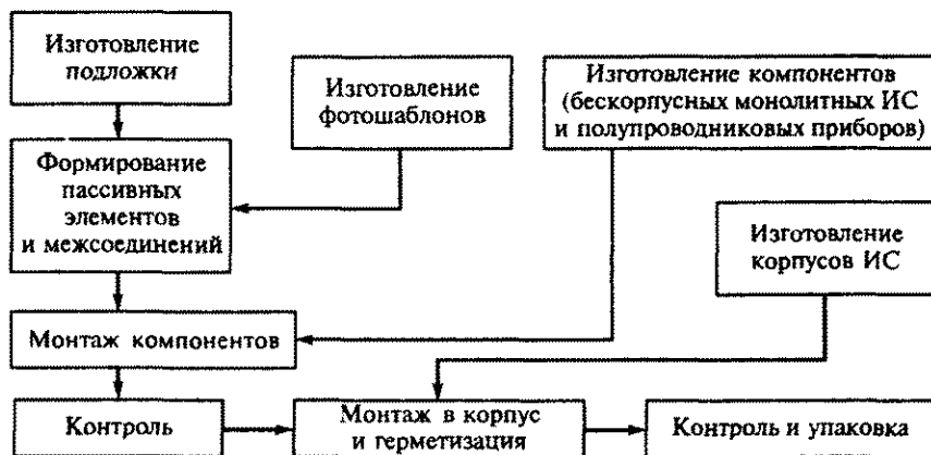
Рис. 7.2. Укрупненная схема ТП изготовления гибридно-пленочных МС
