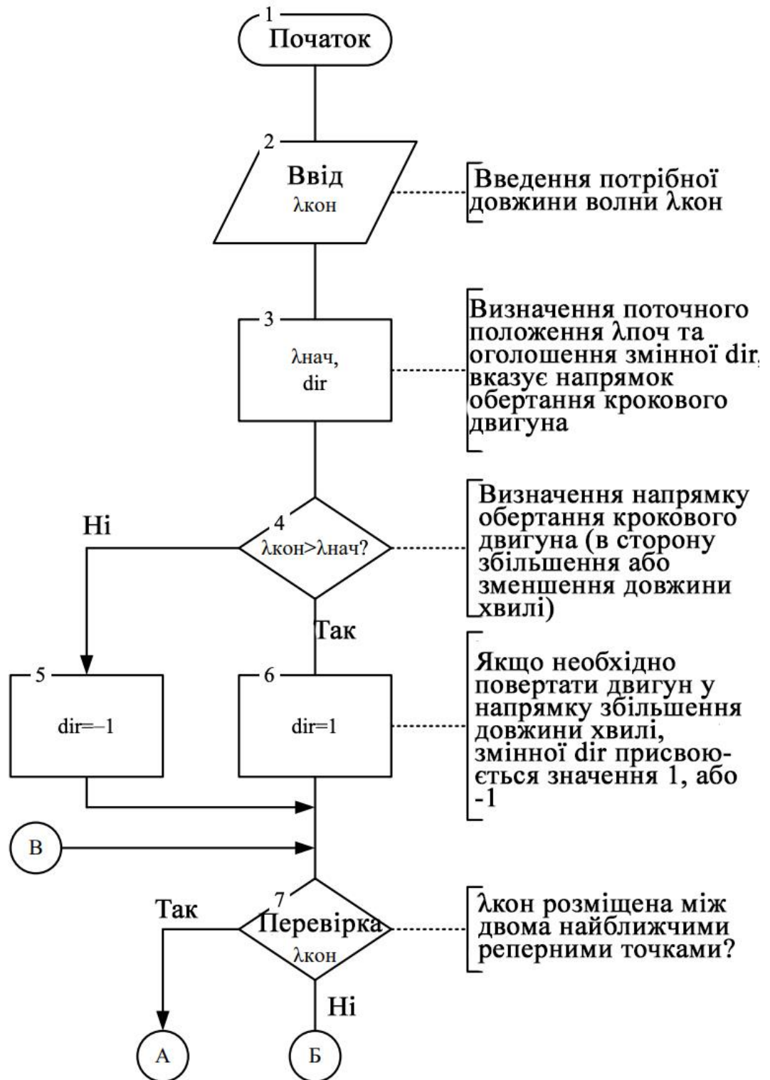
Рисунок 3.12 – Схема оригінального алгоритму установки довжини хвилі (початок)
