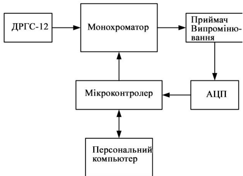
Рисунок 3.14 – Схема експериментальної установки для визначення похибки установки довжини хвилі монохроматора
