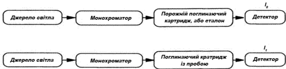
Рисунок 1.6. Принцип кількісного аналізу (визначення відгуків I_0 та I_1 )
