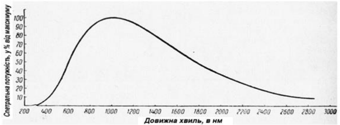
Рисунок 2.1. Спектральний розподіл випромінювання вольфрамової лампи розжарювання (кольорова температура 2842 К).
