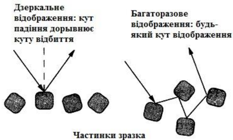
Рис. 1.10. Дзеркальне відбиття (Френеля) від поверхні частинок.
