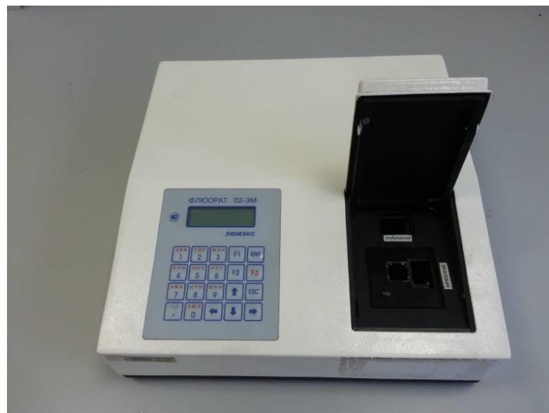
Рис. 3.7. «Флюорат-02» - базовий прилад для групи аналітичних методів: флюориметрії, фотометрії, хемілюмінометрії [14].
