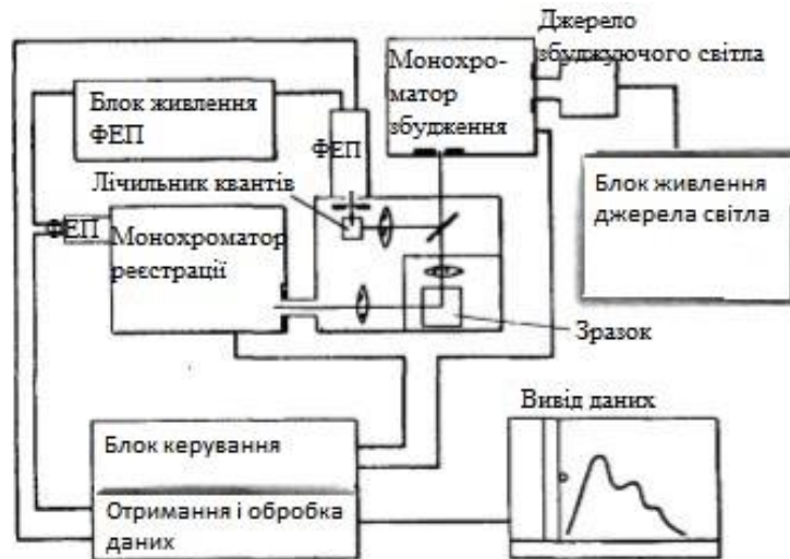
Рис. 2.4. Схема типового спектрофлуориметра
