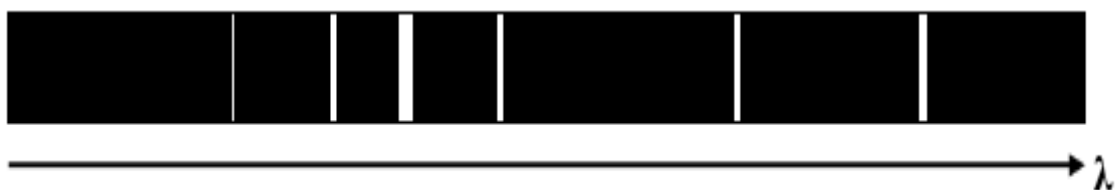
Рис. 1.7. Вид спектру випускання в спектроскопі: на темному тлі видно яскраві лінії випускання речовини.
