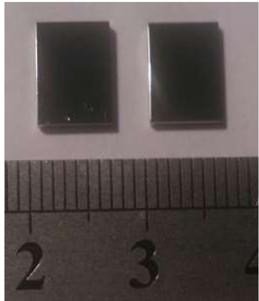
Рис.3.3 Зображення морфології поверхні структур з р-п-переходом, виготовлених дифузійним методом
