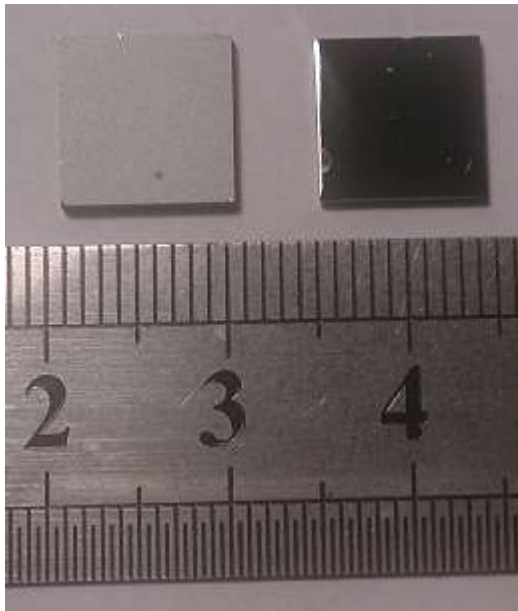
Рис.3.2. Зображення морфології поверхні підкладки після абразивної планаризації (зліва) та після хіміко-динамічного полірування у протравлювачі CP-4
