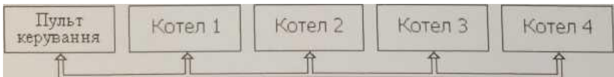
Рисунок 4.18 - Структурна схема комплексу ЕІК-01
