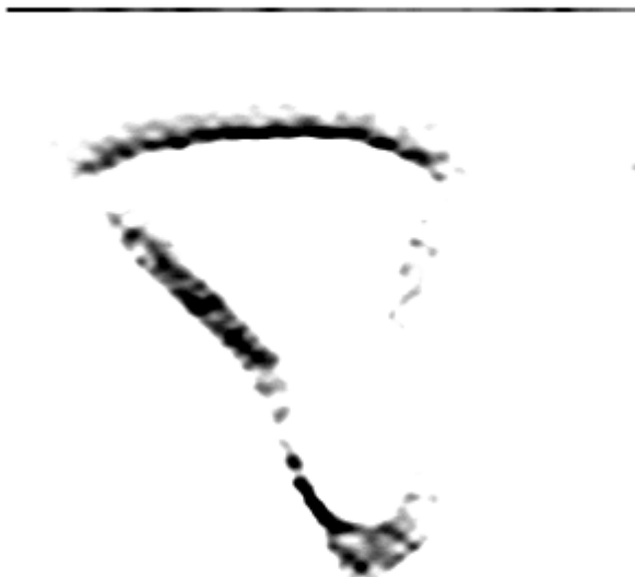
Рис. 2.38 – Порогова фільтрація контуру зони дефекту СЕ: градієнт +45 град; різкість +20
