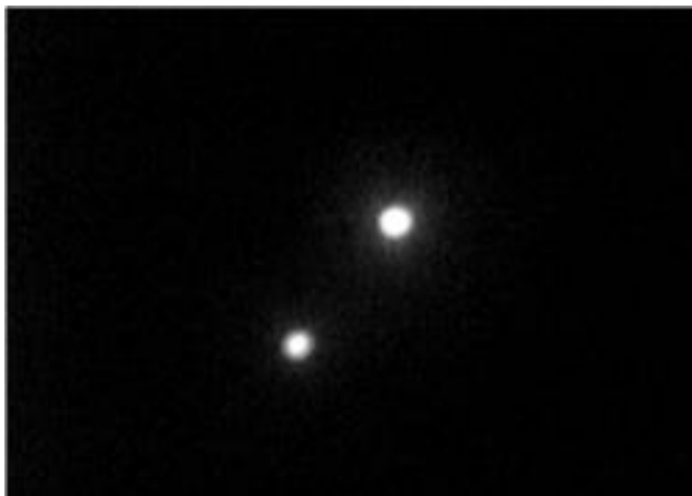
Рис. 2.18 – Парний ЕЛД СЕ: збільшення у 50 раз, відстань між дефектами 200 мкм
