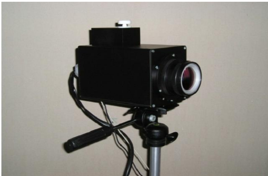
Рисунок 2.10 – Інфрачервоний термограф із охолоджуваним рідким азотом фотоприймачем
