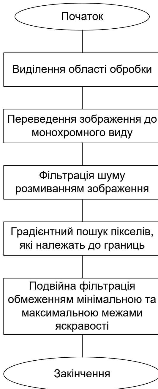
Рис.2.15 – Узагальнений алгоритм контурної фільтрації термограм за методом Кенні
