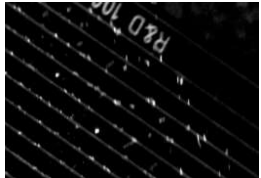
Рис.2.18 – Частина осередку контролю (із збільшенням 2): дефекти мають вигляд крапок і плям, що світяться; а)пластина без підключення до зовнішнього джерела; б) через пластину тече темновий зворотний струм 0,3А від зовнішнього джерела, яскравість дефектів зросла, збуджено розряд над прихованими дефектами
