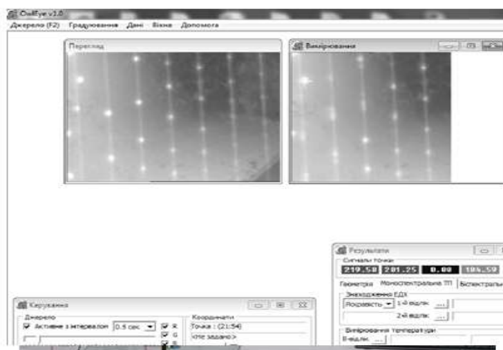
Рис.2.19 - Робочі вікна програми Owley: часова затримка зображення праворуч дорівнює 4 с відносно зображення ліворуч; помітні рухомі яскраві об'єкти – це нові місця іскрового пробую
